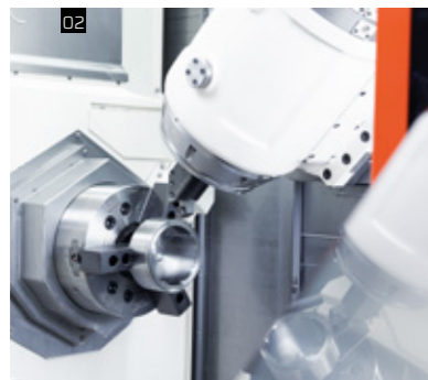
01 Eine voll klimatisierte Fertigung und ein moderner Maschinenpark sorgen für optimale Produktionsbedingungen am Firmensitz in Rankweil (AT) 02 Multi-Funktions-Maschine der neuesten Generation ermöglicht eine DONE-IN-ONE Bearbeitung vom Rohling bis zum fertigen Dreh- & Fräsbauteil 03 Unser Verständnis von Genauigkeit liegt im tausendstel Millimeter 04 Medienverbindungen werden bei STARK Schnellverschlussplatten tieflochgebohrt
