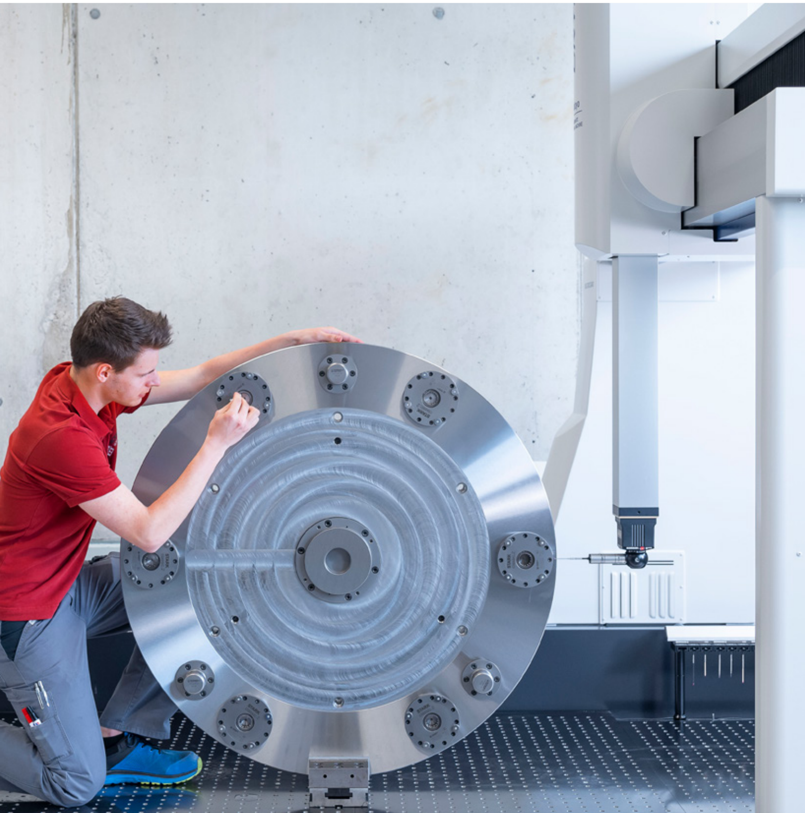
Qualitätskontrollen erfolgen in einem klimatisierten Messraum. Kundenspezifische Schnellverschlussplatte mit 1,1 m Durchmesser für Schleifanwendungen im Luftfahrtbereich.
