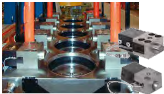
5-stopniowa prasa do kucia matrycowego wyposażona w dociski klinowe z zaworami gniazdowymi do niezależnego zasterowania poszczególnych gniazd.
