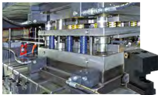
Dociski suwliwe ze stopą T zabudowane w stole prasy i suwaku, listwy rolkowe i konsola transportowa dla łatwego wprowadzania narzędzi do przestrzeni roboczej prasy.
