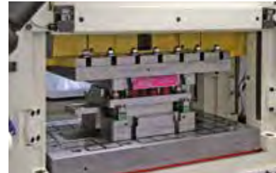
System mocowania magnetycznego M-TECS 80 dla przetwórstwa blach. Temperatury do 80 °C
