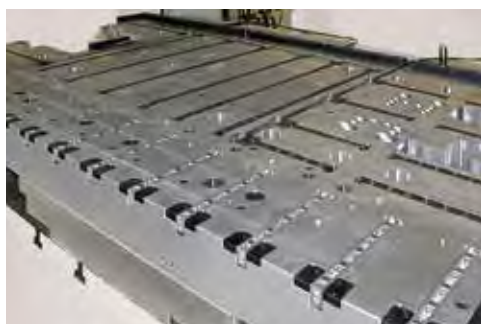
Listwy rolkowe podnoszone hydraulicznie zabudowane w stole prasy.
