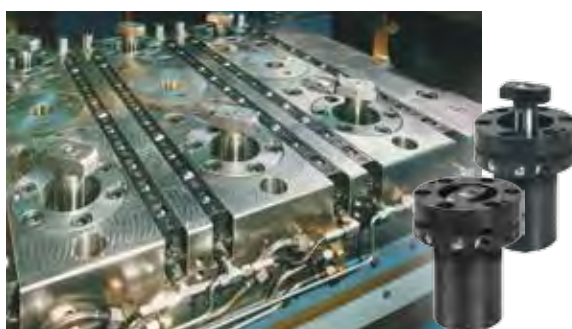
Dociski skrętno-ciągące zabudowane w stole prasy bramowej (końcówka mocującą T do docisku wysunięta w pozycji mocującej).
