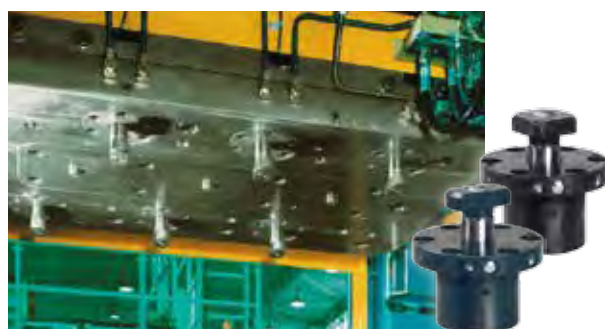
Dociski mocujące skrętnie w suwaku prasy. Pozycja zmiany narzędzia; suwak prasy w górnym położeniu, docisk mocujący wysunięty.
