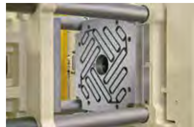
System mocowania magnetycznego M-TECS 120 dla przetwórstwa tworzyw sztucznych. Temperatury do 120 °C
