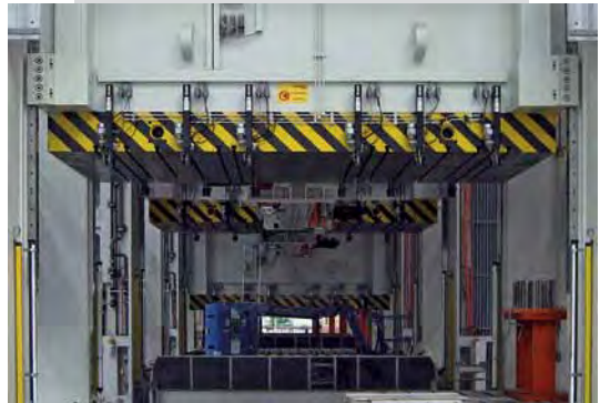
Spannelemente an einer Transfer-Großpresse der Fa. Schuler.
