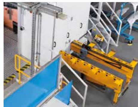
Werkzeug-Wechselkonsole mit Antrieb und seitlicher Beladung der Presse.
