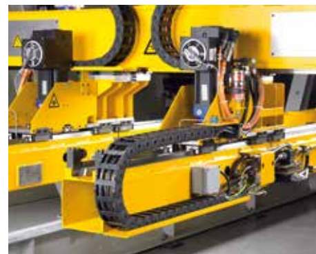
3-Achs-Transfersystem mit hydraulischer Greiferschielen-Kupplung (Transferschielenkupplung)
