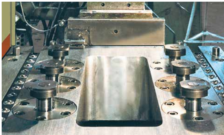
Zugspannelemente im Pressentisch einer Zweiständerpresse.
