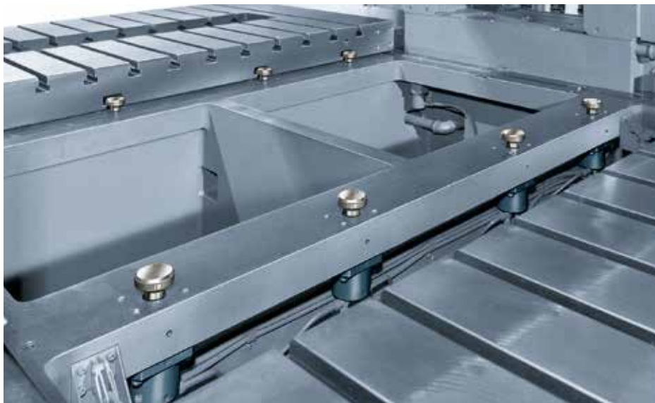
Spannen eines Wechseltischs mit Zugspannelementen
