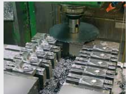
Nach der Fertigbearbeitung wird der „verlorene Kopf“ mit einem Scheibenfräser vom Werkstück abgetrennt.
