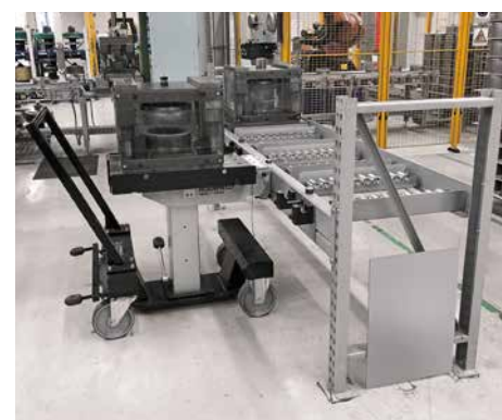
Półautomatyczne dokowanie wózka do wymiany narzędzi RW 500 i systemu regałowego
