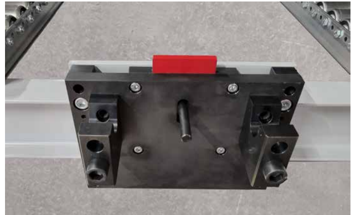
Półautomatyczne haki dokujące i rygiel zabezpieczający zamontowane na systemie regałowym zaprojektowanym dla wózków do wymiany narzędzi RW/RWA 500
