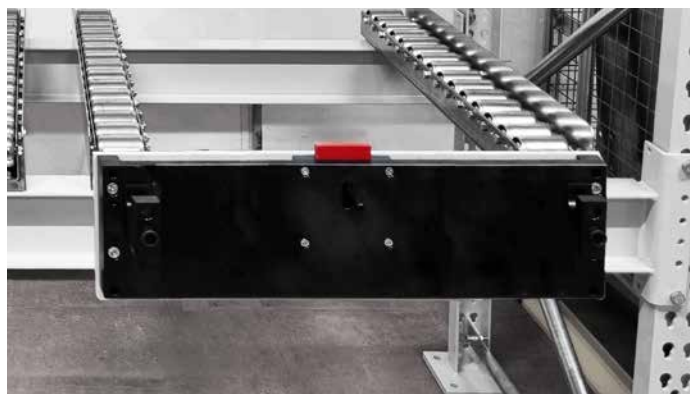
Półautomatyczne haki dokujące i rygiel zabezpieczający zamontowane na systemie regałowym zaprojektowanym dla wózków do wymiany narzędzi RW/RWA 1000
