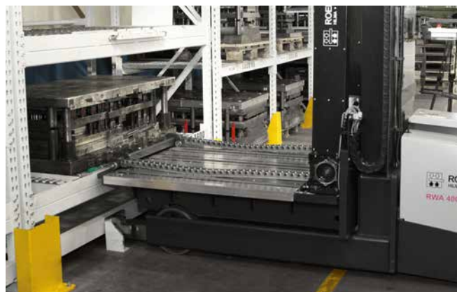
System regałowy z listwami dokującymi i wózkiem do wymiany narzędzi RWA 4000 z łańcuchem push-pull
