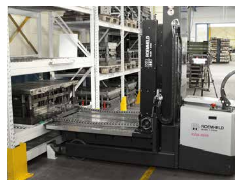
System regałowy z listwami dokującymi i wózkiem do wymiany narzędzi RWA 4000 z łańcuchem push-pull
