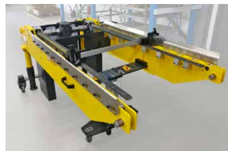
Widok łańcucha push-pull i adaptera do narzędzia
