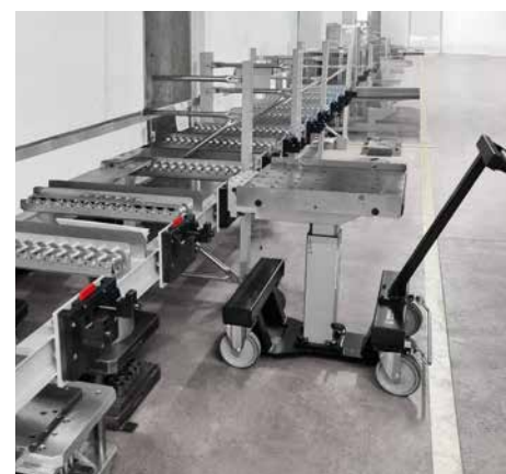
System regałowy z hakami dokującymi i wózkiem do wymiany narzędzi RW 500
