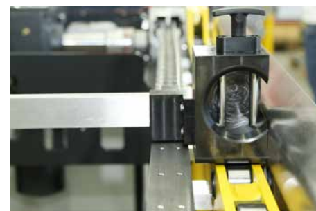
Urządzenie dokujące push-pull indywidualnie dostosowane do potrzeb klienta
