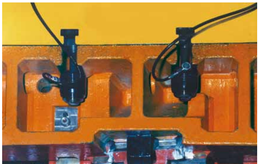
Einsatz von Hohlkolbenzylindern am Pressenstößel
