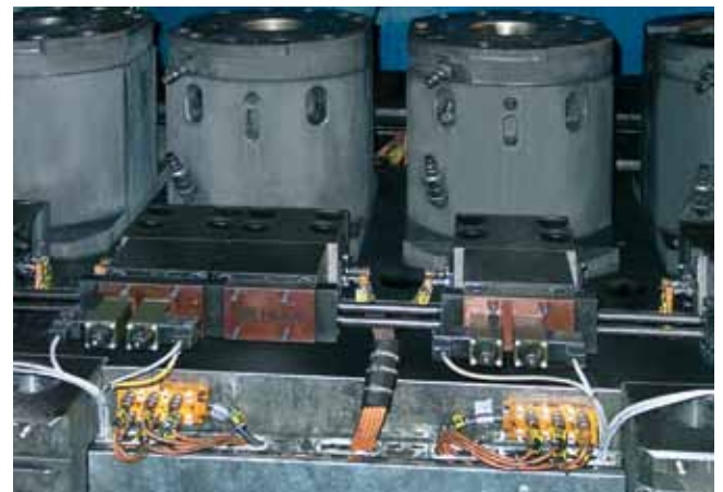
Keilspannelemente mit direkt angeflanschten Wegesitzventilen. Spann- u. Löseposition elektr. überwacht. Geringer Montageaufwand durch Steckverbindungen zwischen den Spannelementen.
