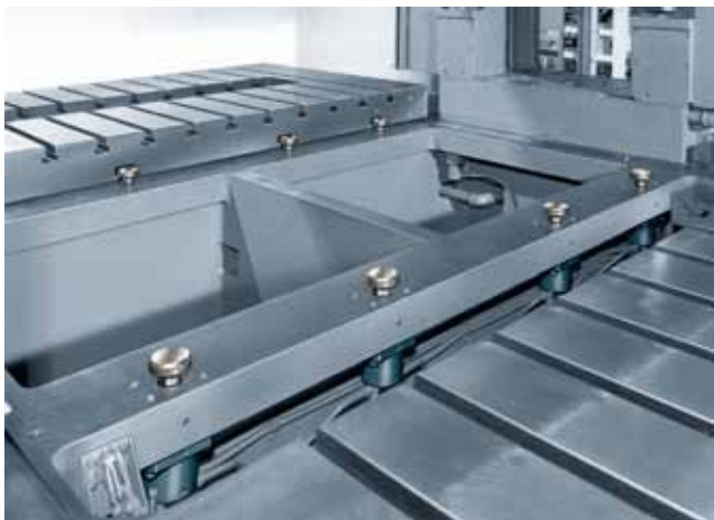
Spannen eines kompletten Wechseltisches mit Zugspannelementen
