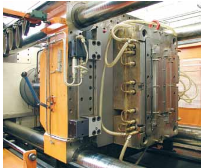
Keilspanner mit Rückschlagventil auf einer Krauss Maffei KM 575 Spritzgießmaschine
