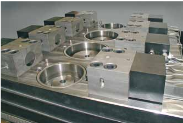
Keilspanner in einem Schmiedegesenk Temperaturen bis 250 °C
