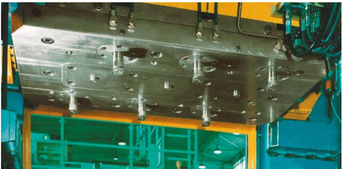
Einsatz von Schwenkspannelementen im Pressenstößel. Dargestellt ist die Werkzeugwechselposition, d.h. Stößel in oberer Stellung und Schwenkspanner ausgefahren.
