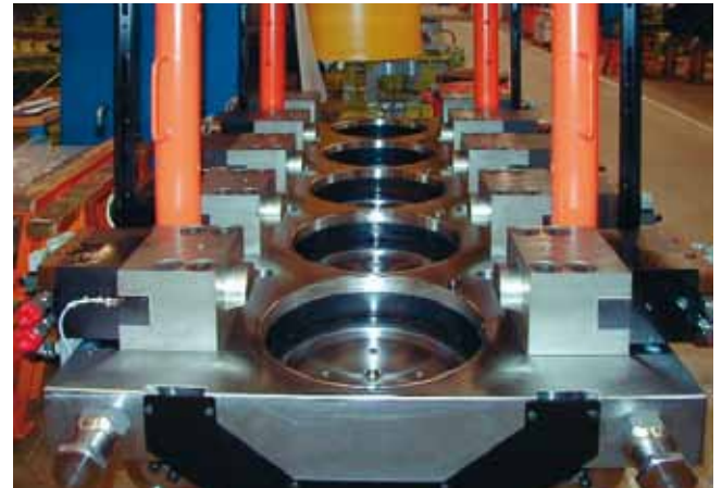
5-stufige Gesenkschmiede, ausgestattet mit Keilspannelementen mit Wegesitzventilen zur Ansteuerung der einzelnen Stufen
