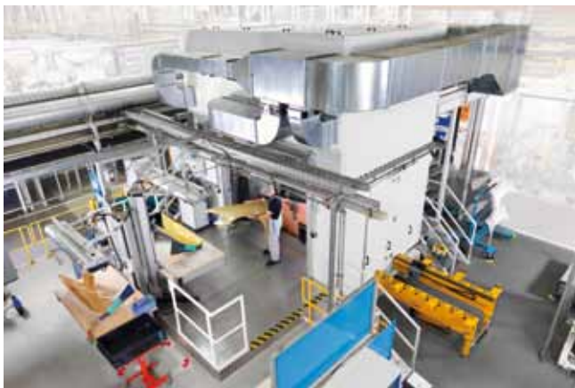
Werkzeug-Wechselkonsole mit Antrieb und seitlicher Beladung der Presse.
