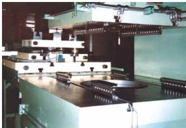
Doppel-T-Spannleiste an Pressentisch und Pressenstößel
