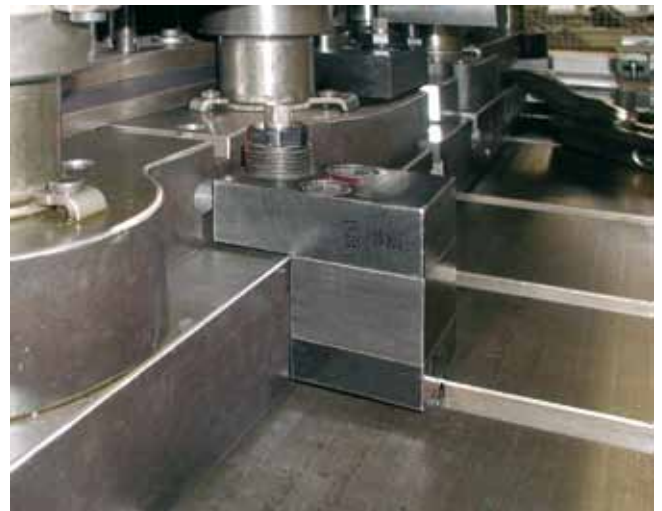
Einsatz von mechanischen Einschubspannelementen auf einem Maschinentisch
